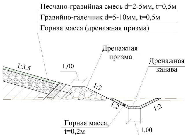
Рис.8 Конструкция дренажа плотины
