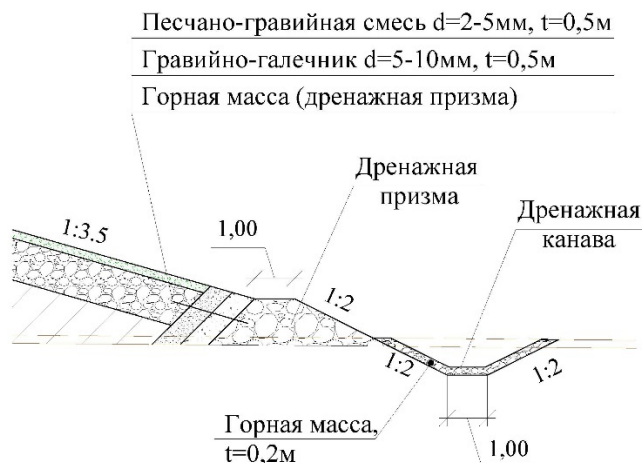
Рис.8 Конструкция дренажа плотины
