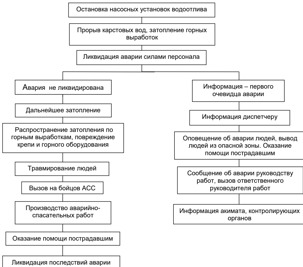
Рисунок 7.3 – Блок-схема анализа вероятных сценариев возникновения и развития аварий при затоплении штольни
