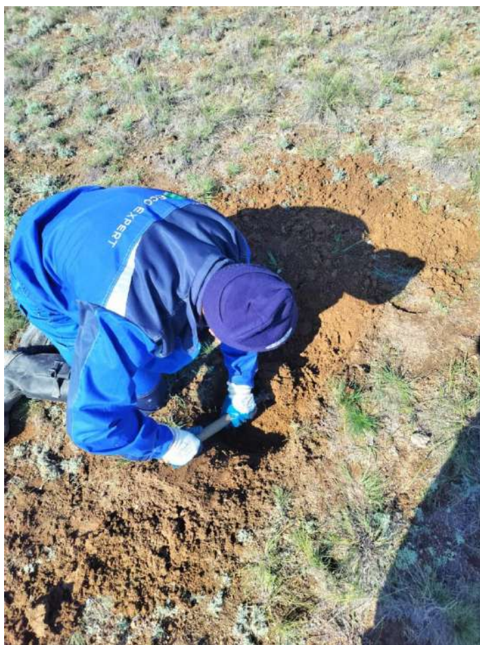
Рисунок 2.3 – Отбор проб почвы на участке
