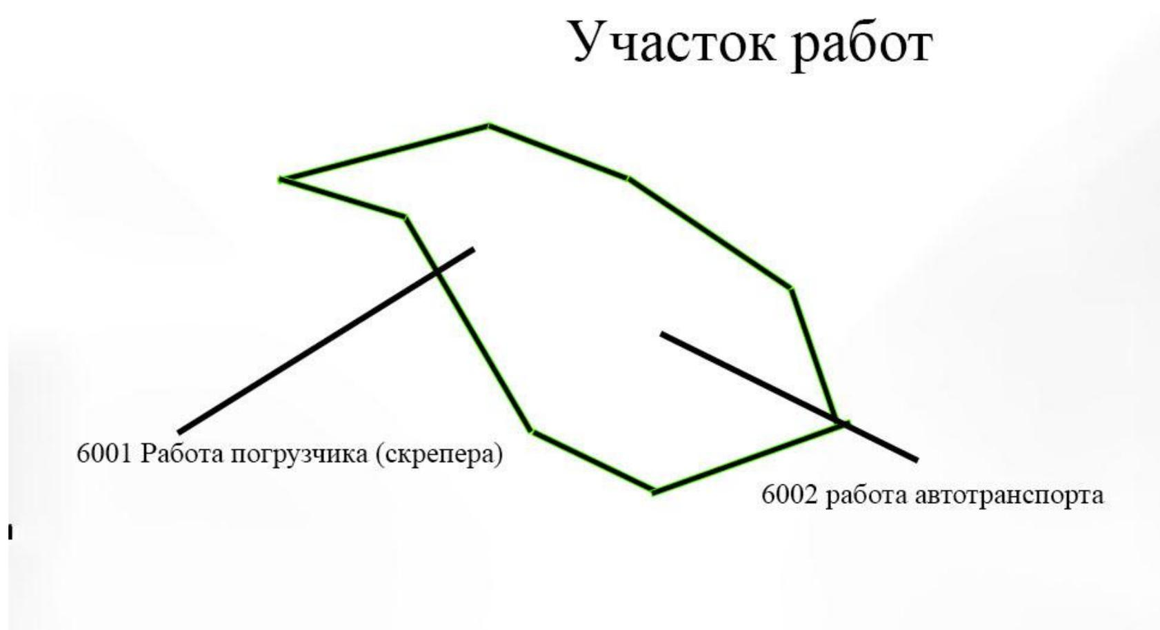
Рис.3 План-схема с отмеченными источниками выбросов загрязняющих веществ
