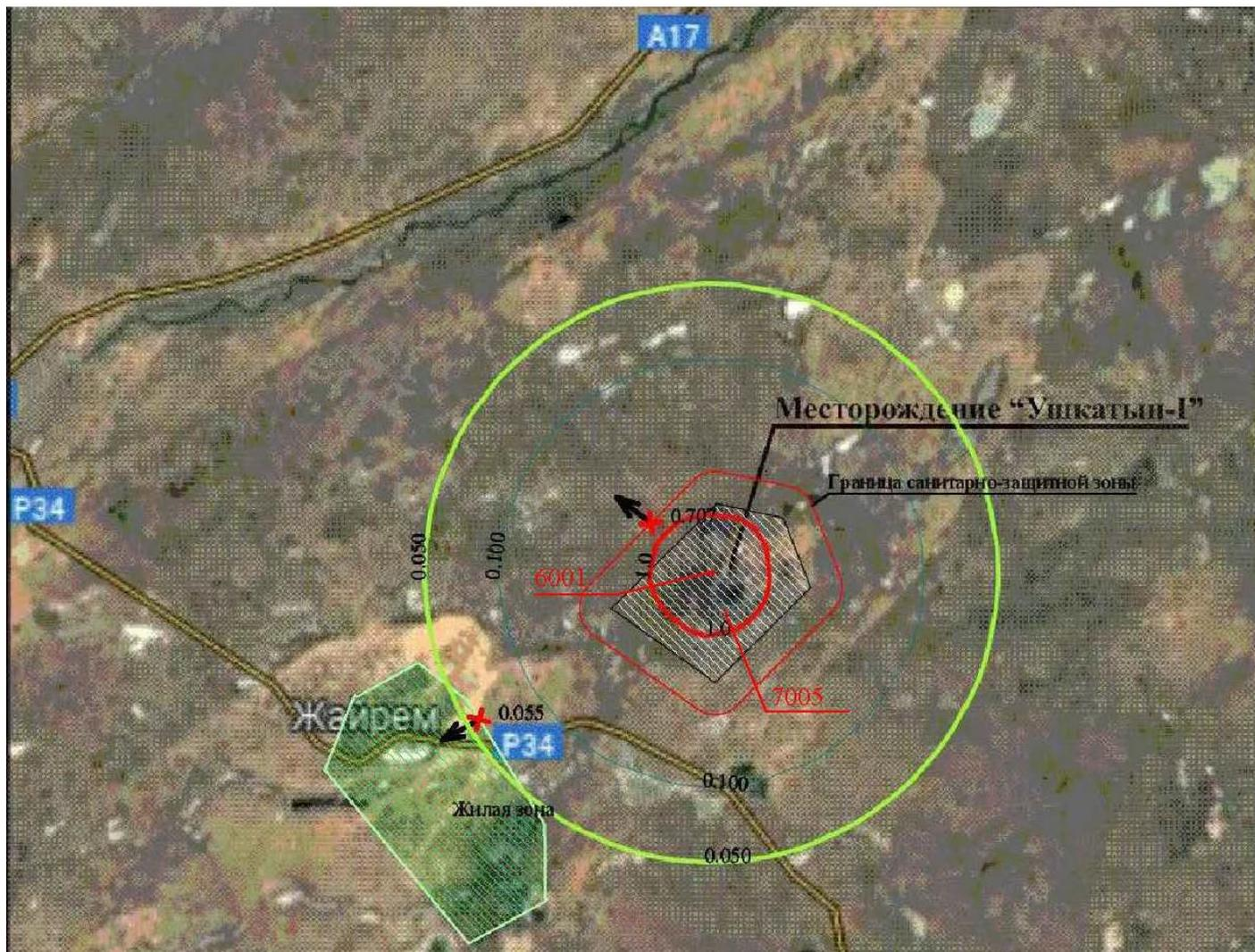
Рис. 2 – Схема санитарно-защитной зоны и расположения источников загрязнения атмосферного воздуха период проведения ликвидации
