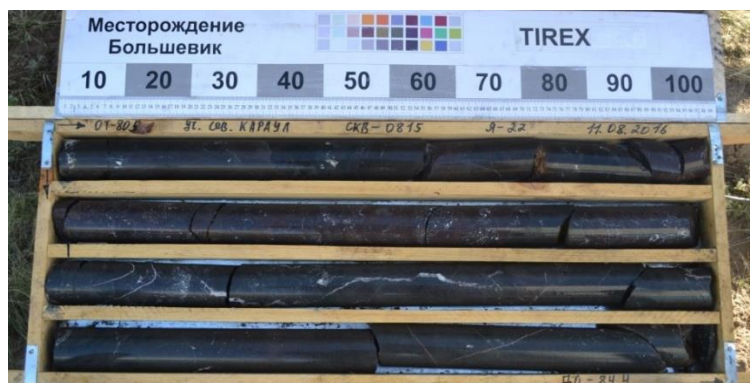
Рис. 5.5.1.2 Пример линейки и цветной/черно-белой контрольной полосы, для корректировки цветового баланса при фотографировании керна
