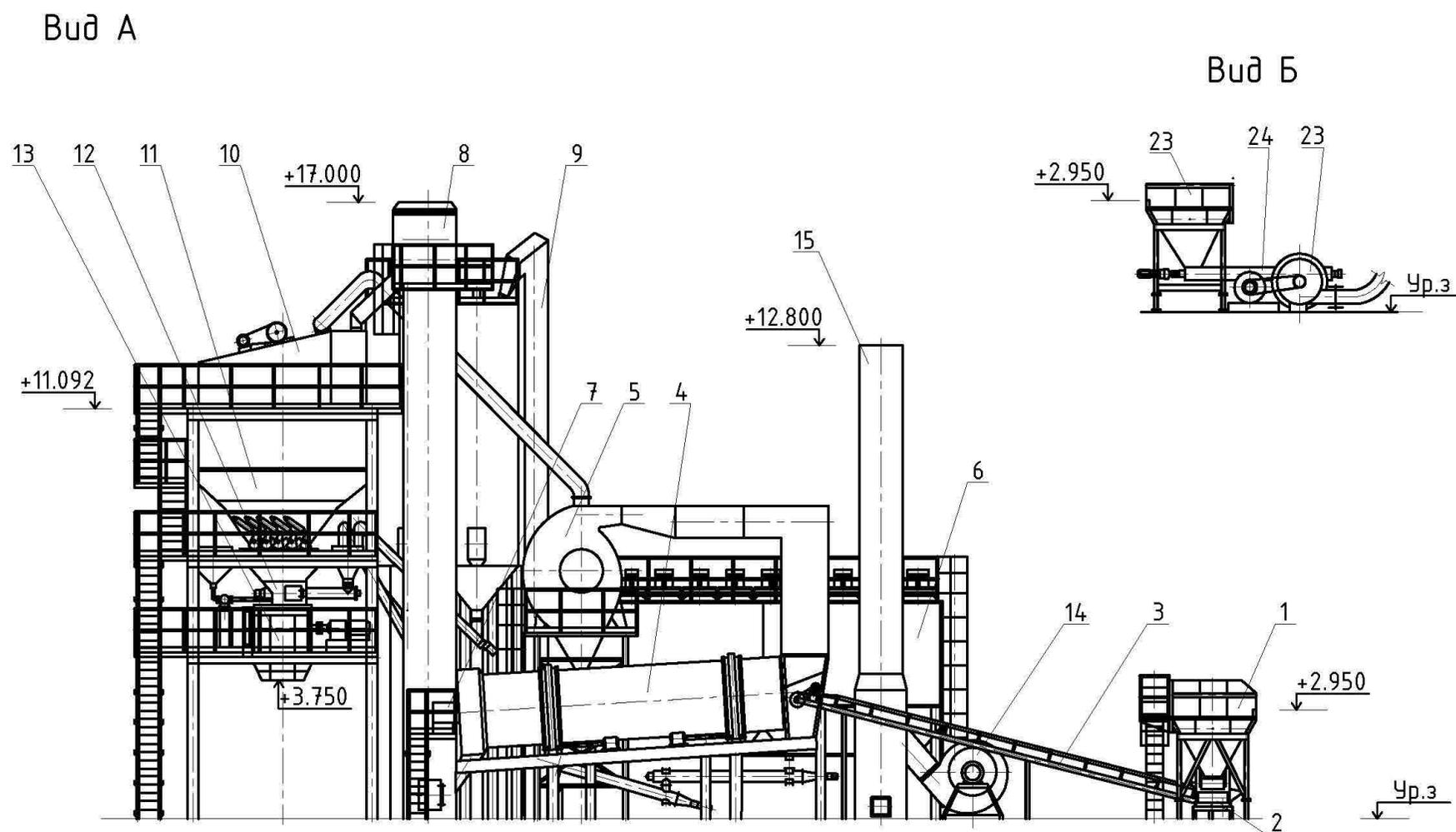
Рисунок 3 – Схема асфальтобетонного завода марки RD175B
