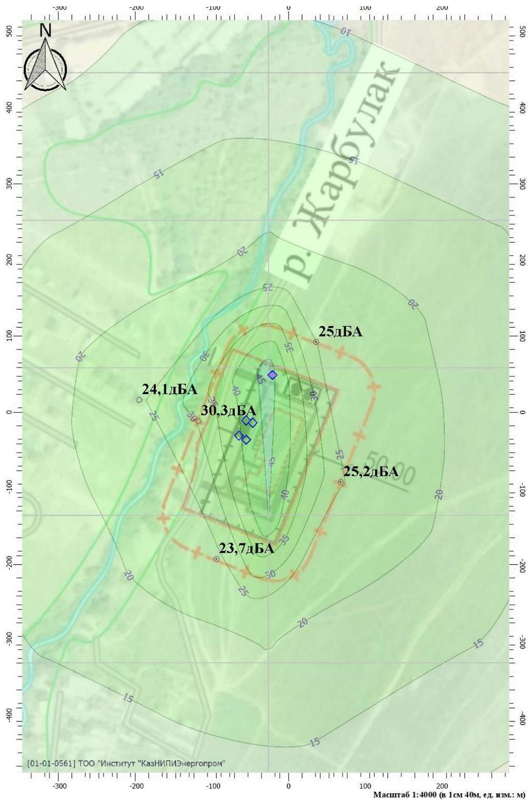
**Рисунок 5.10.** Карта акустического воздействия котельной в период эксплуатации
