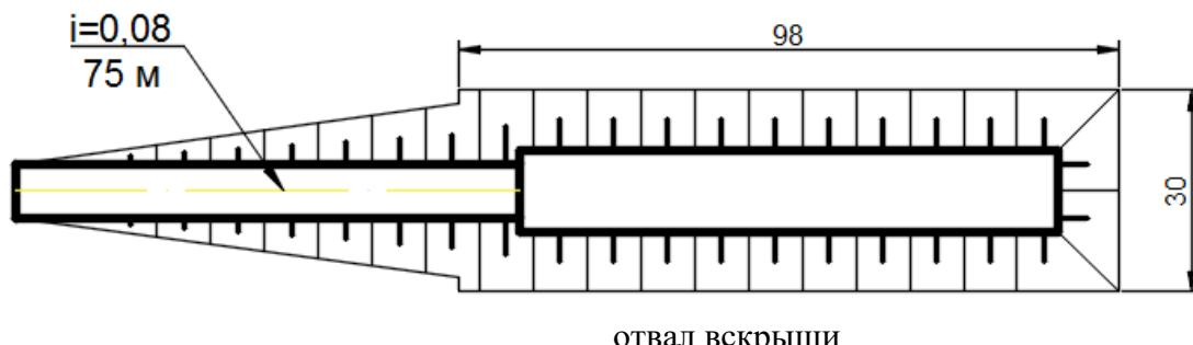
Отвал будет состоять из двух участков по фронту разгрузки. На первом участке будет происходить разгрузка, второй будут производиться планировочные работы.
