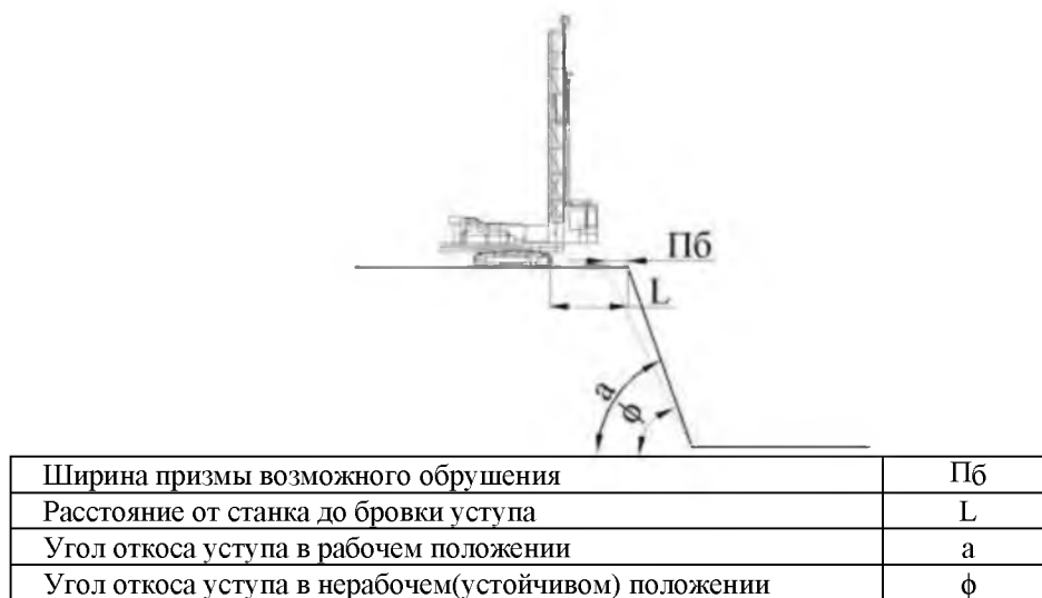
Рис. 4. Размещение бурового станка на уступе
