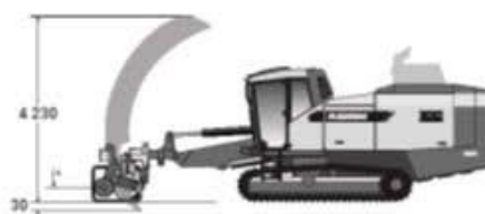
Охват при бурении вертикальных скважин с коротким податчиком
