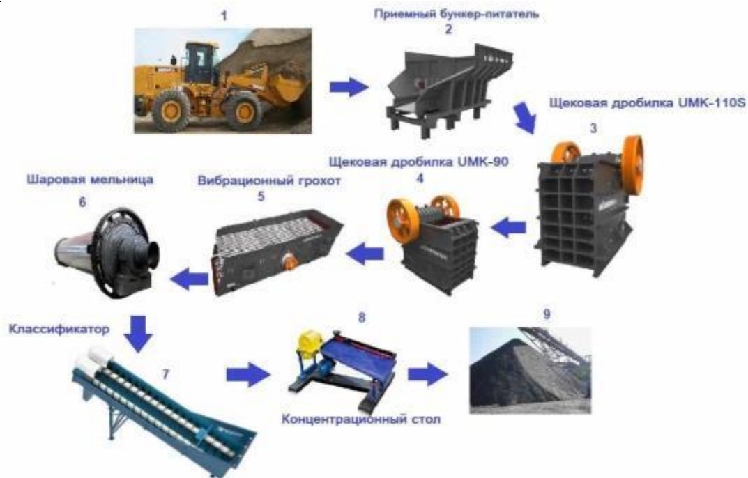
Схема работы дробильно-сортировочной установки
