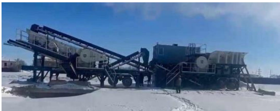
Мобильная первичная дробильная установка UMA90M
