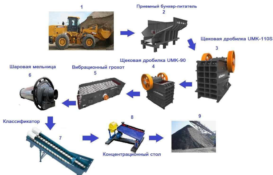
Рис. 5.1 – Схема работы дробильно-сортировочной установки
