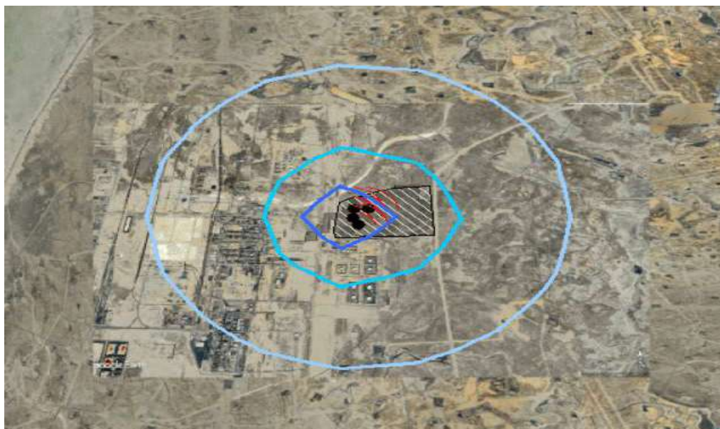
Рисунок 6.1.4.2. Расчет уровней шума при на период строительства (эквивалентный) (2025 г.)
