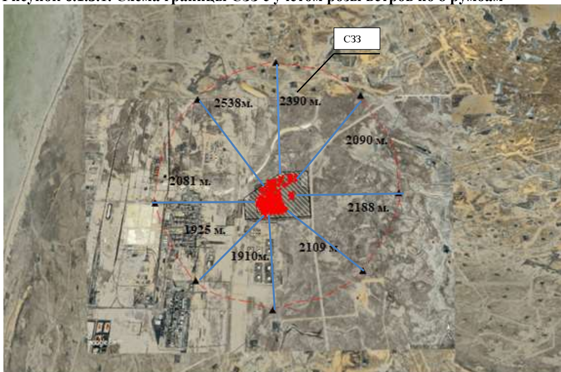
Рисунок 6.1.3.1. Схема границы СЗЗ с учетом розы ветров по 8 румбам
