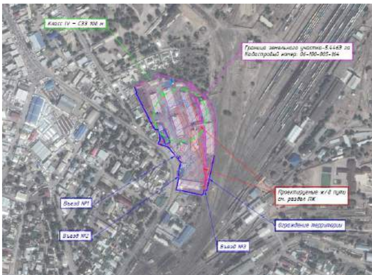
Рисунок 2 Предусмотренный размер СЗЗ (100 м) для проектируемого цеха сервисного обслуживания локомотивов
