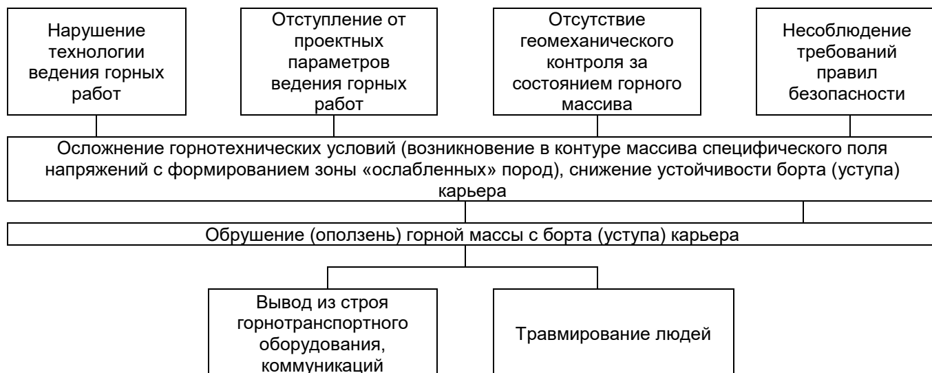
Рисунок 7.1 – Блок-схема вероятного сценария аварии при обрушении (оползней) горной массы с борта (уступа) карьера
