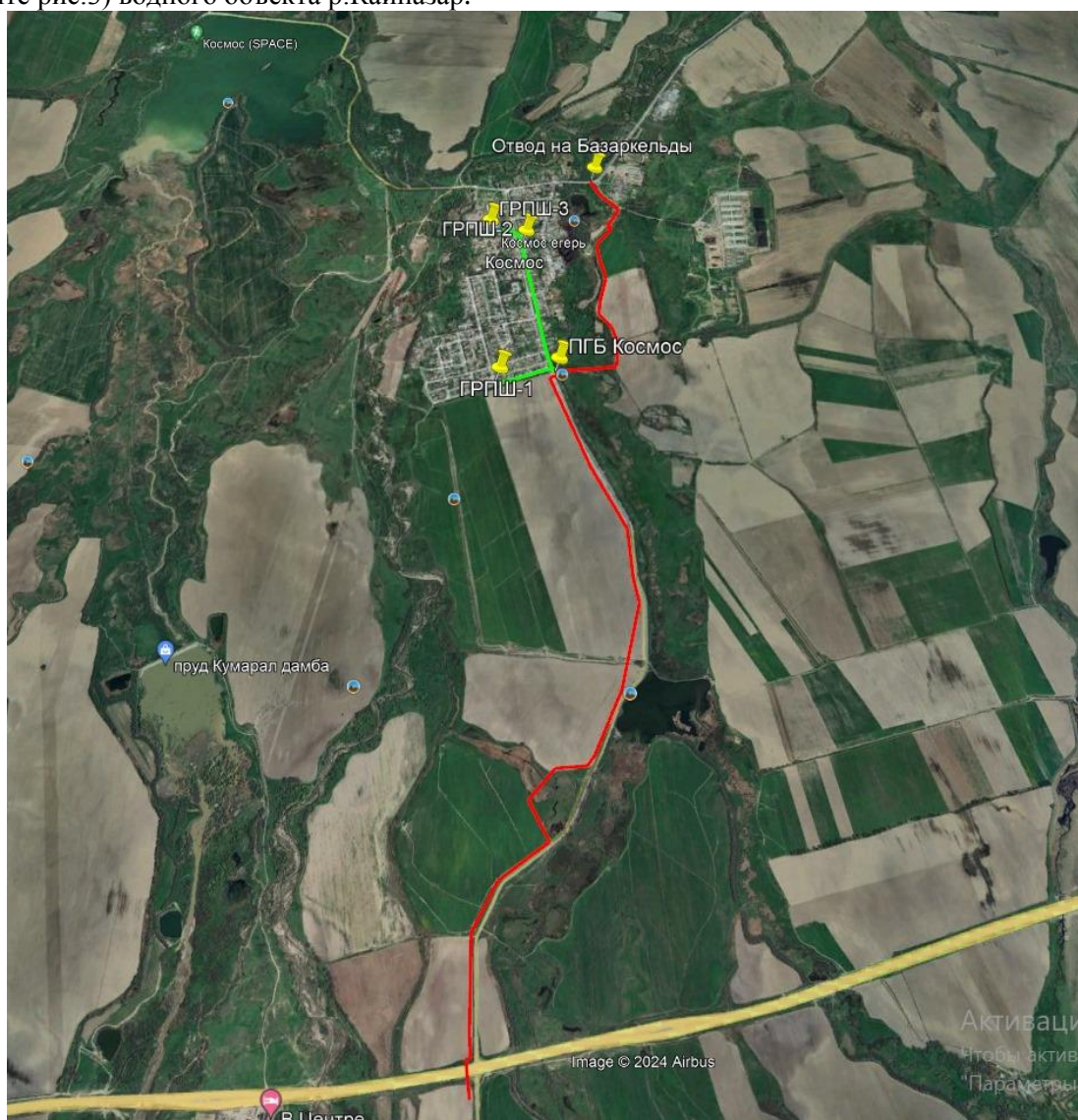
Рис.1 Проектируемые газопровод и газораспределительные сети с. Космос
