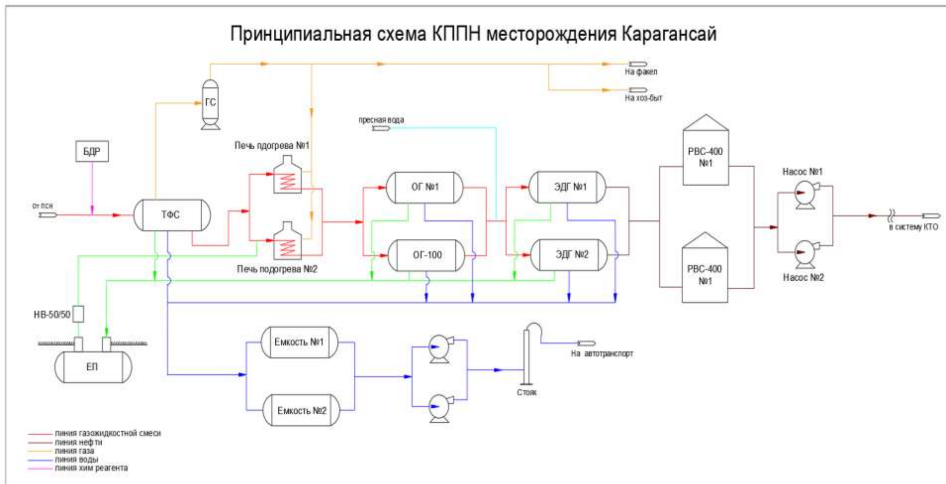
Рис. 2.5.2 – Принципиальная схема системы подготовки нефти Карагансайского участка
