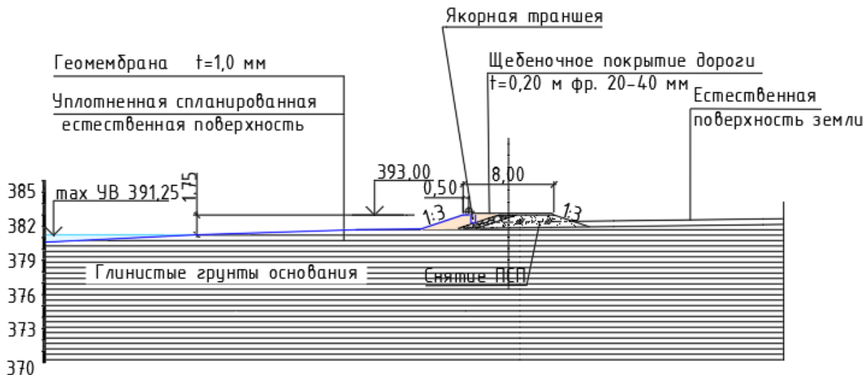
Рисунок 21 - Конструкция участка расширения 2-го этапа
