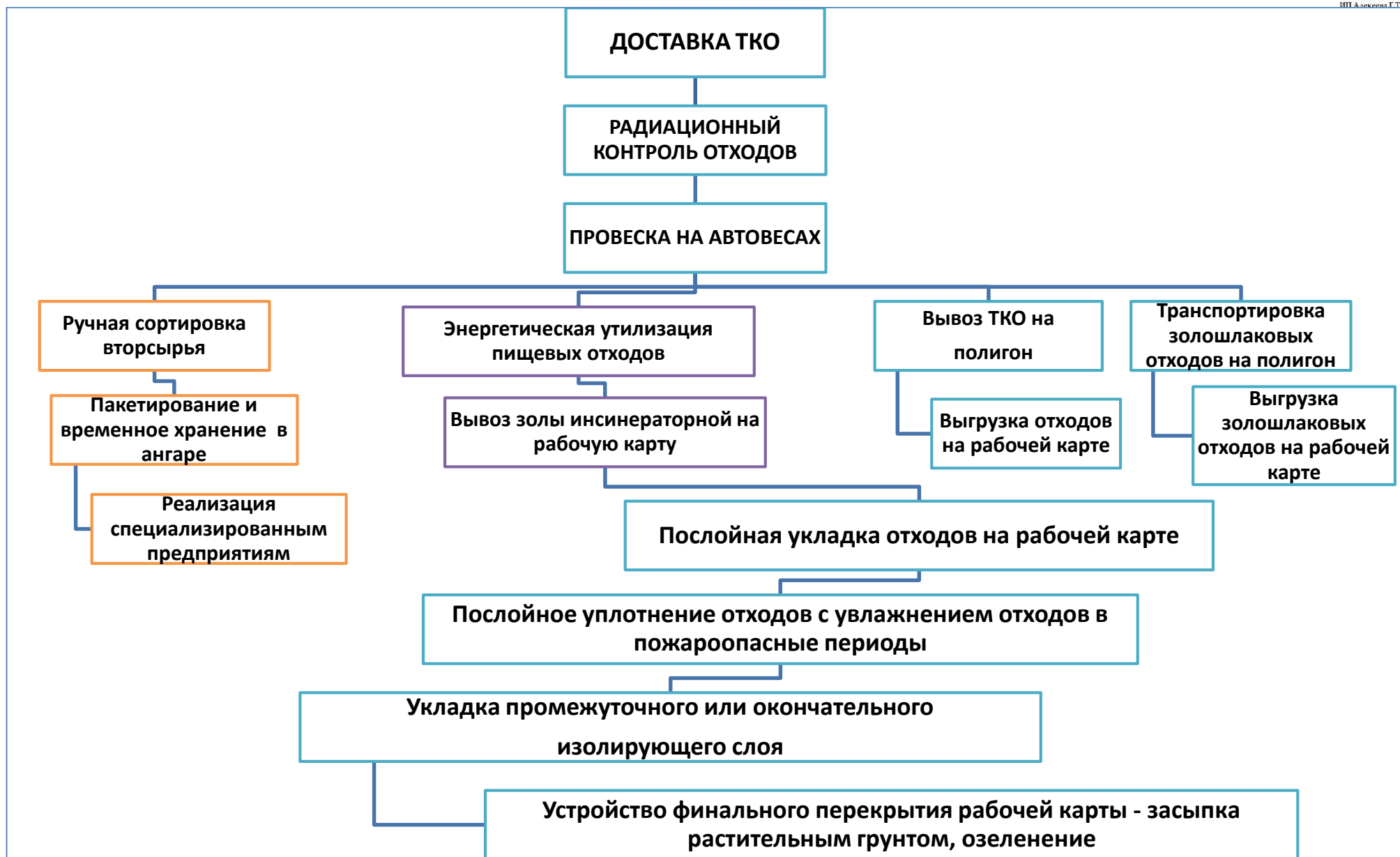
Рис. 1. 11 – Технологическая схема эксплуатации полигона ТБО г. Темиртау
