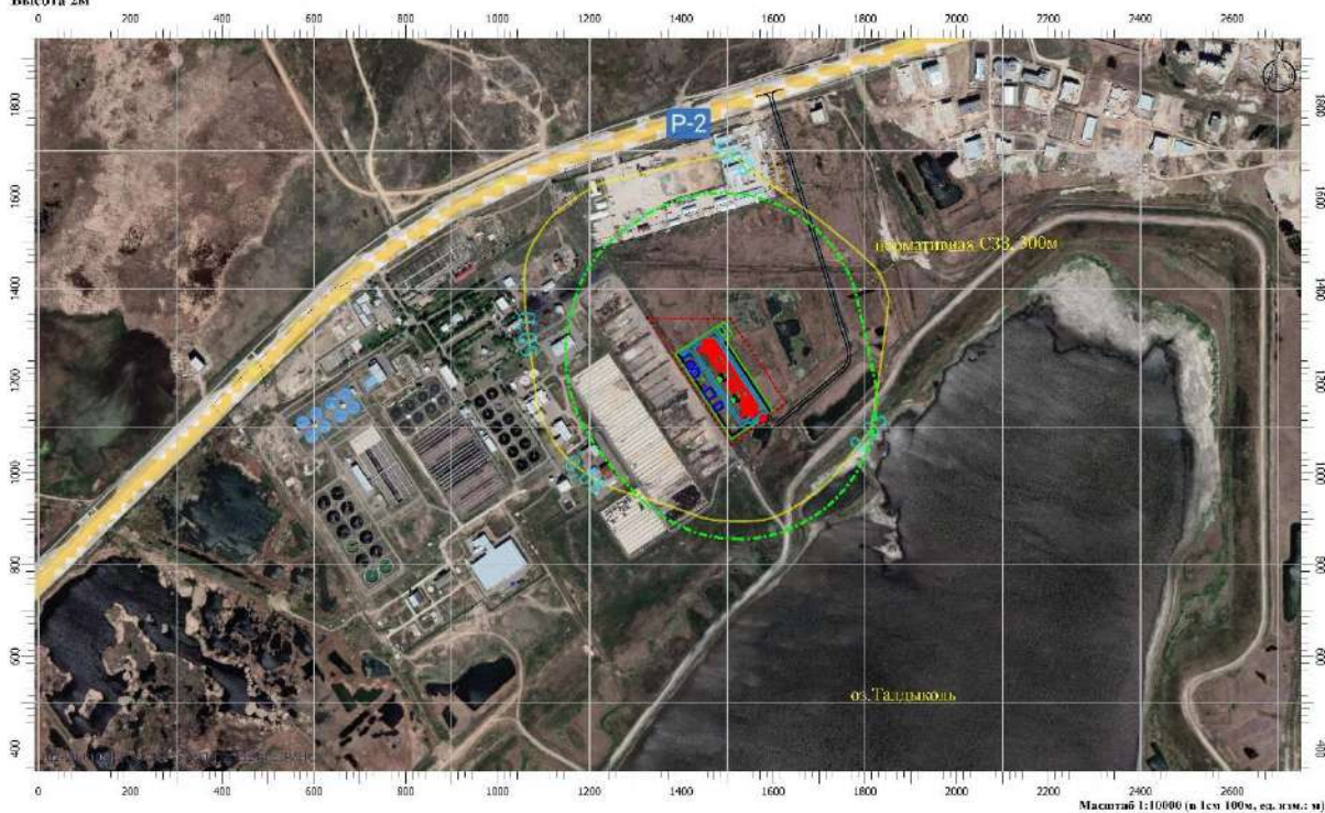
Рис.2. Карта рассеивания загрязняющих веществ в атмосфере при работе котельной Туран. Зима. 1ая очередь. Ингредиент 604 Оксид азота. Сф = 0..
