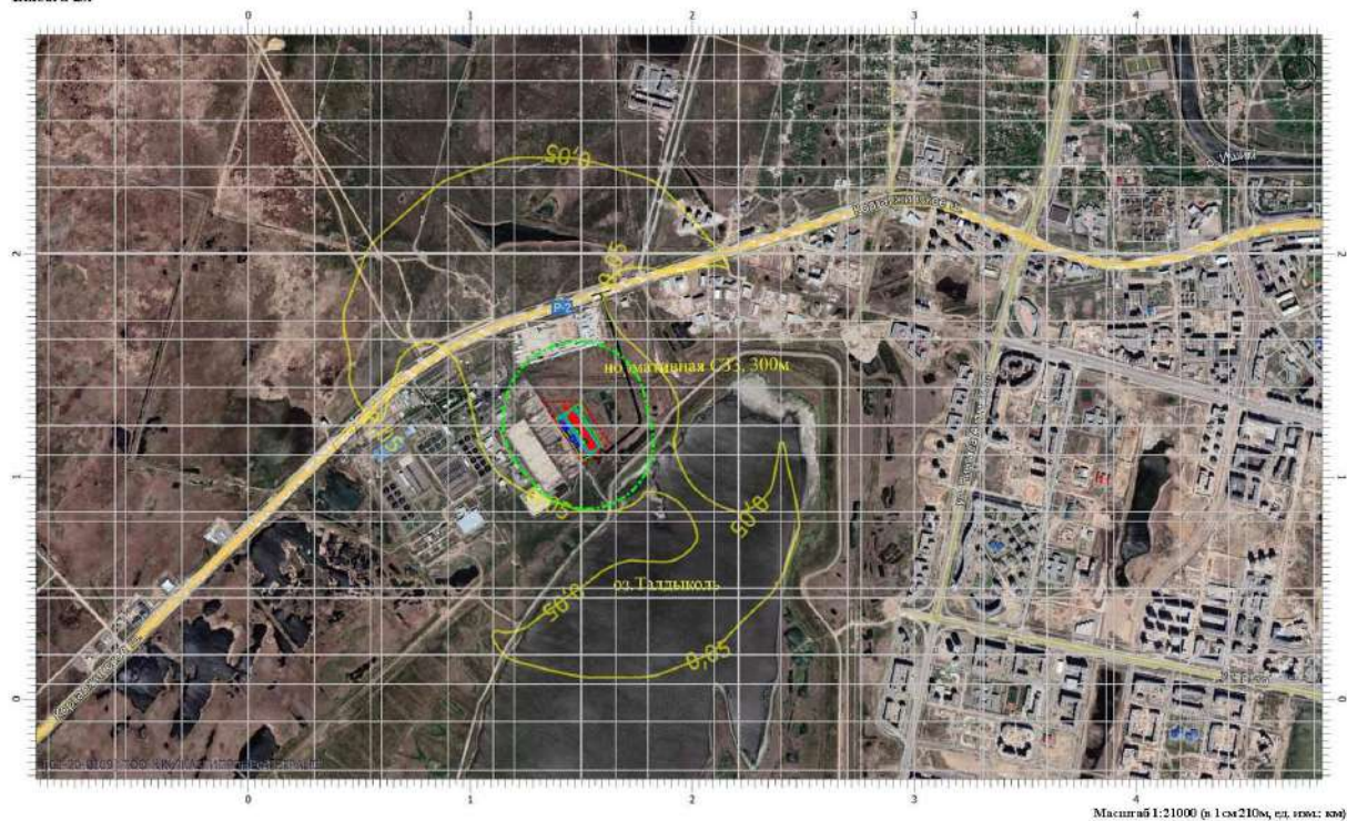
Рис.10. Карта рассеивания загрязняющих веществ в атмосфере при работе котельной Туран. Зима. Полное развитие. Ингредиент 304 Оксид азота. Сф = 0.
