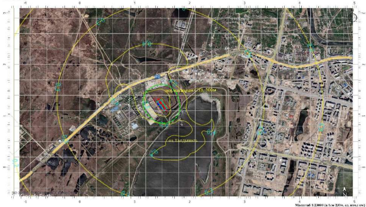
Рис.12. Карта рассеивания загрязняющих веществ в атмосфере при работе котельной Туран. Зима. Полное развитие. Ингредиент 6204. Суммация Диоксид азота и диоксид серы. Сф = 0.
