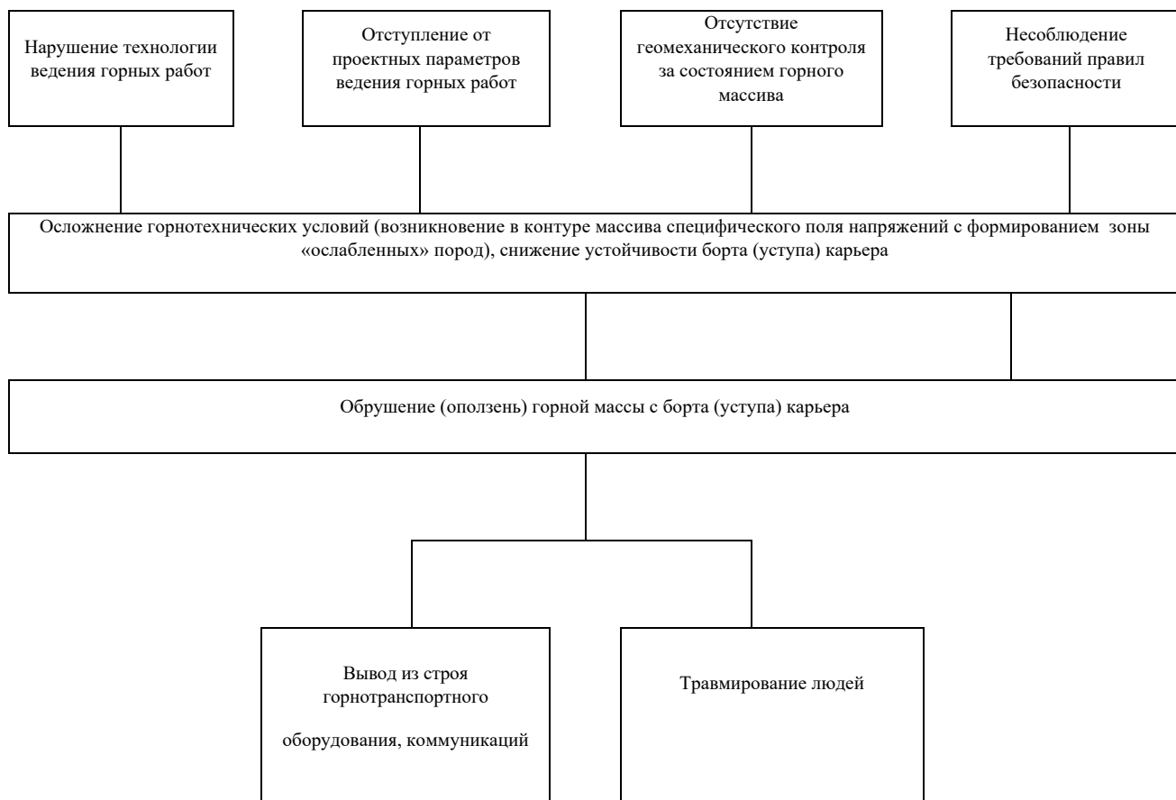
Рисунок 9.1 - Блок-схема вероятного сценария аварии при обрушении (оползней) горной массы с борта (уступа) карьера
