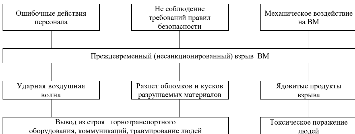
Рисунок 9.2 - Блок-схема вероятного сценария аварии при преждевременном (несанкционированном) взрыве ВВ при проведении взрыва в блоке с механизированным заряджанием скважин
