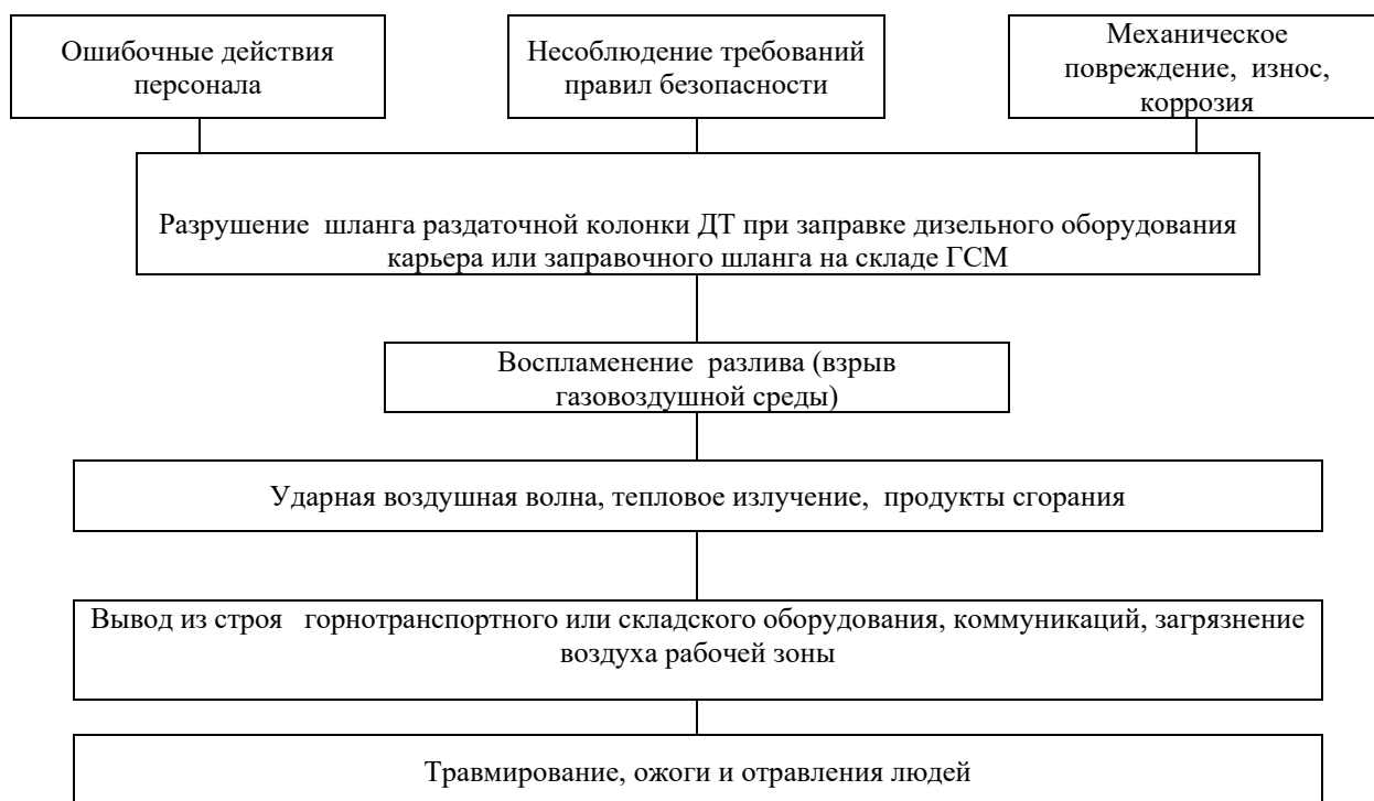
Рисунок 9.3 - Блок-схема вероятного сценария возникновения и развития аварии при заправке дизельного технологического оборудования карьера из топливозаправщика или заправке емкости на складе ГСМ
