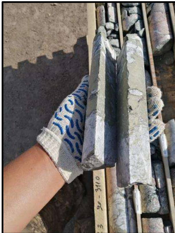
Рисунок 6.10 - Керн, распиленный на две равные половины
