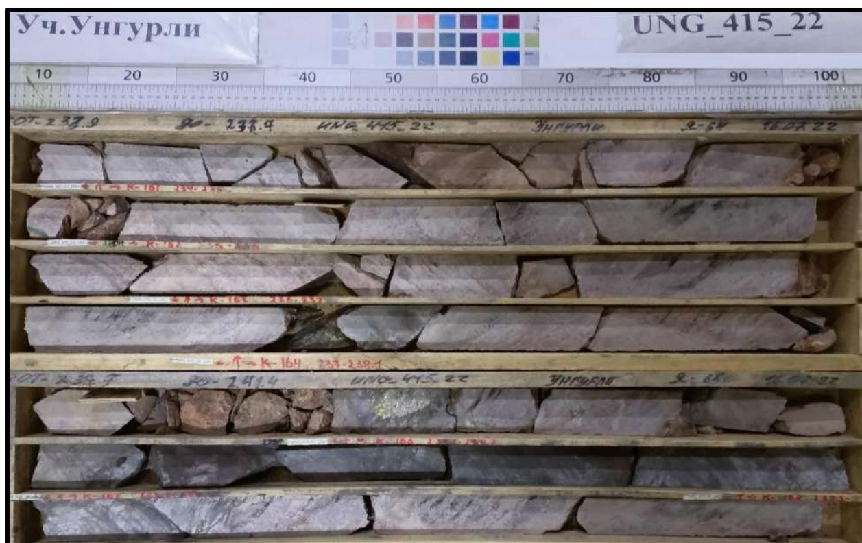
Рисунок 6.9 - Фотография керна после кенового опробования
