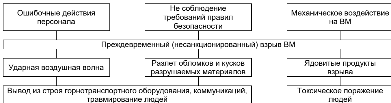
Рисунок 7.2 – Блок-схема вероятного сценария аварии при преждевременном (несанкционированном) взрыве ВВ при проведении взрыва в блоке с механизированным заряданием скважин
