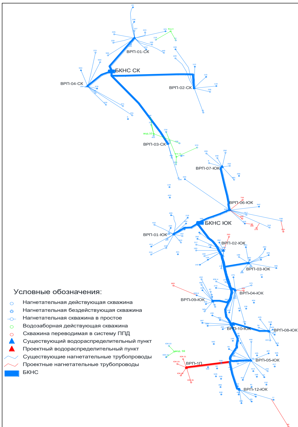
Рисунок 1.5.7.4 – Схема системы ППД месторождения Коньес с проектными решениями
