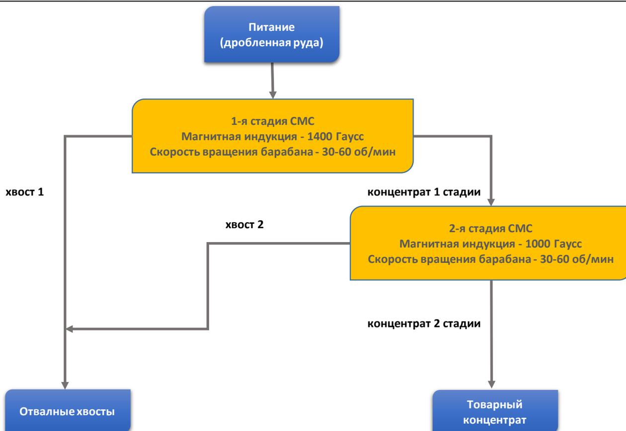
Рисунок 2 – Технологическая схема дробления руды месторождения «Бенкалинское»
