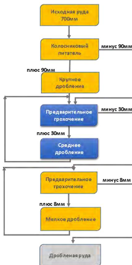
Рисунок 1 – Технологическая схема дробления руды месторождения «Бенкалинское»
