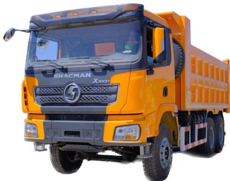
Рисунок 6.2 – Самосвал SHACMAN X3000 грузоподъемностью 25 т
