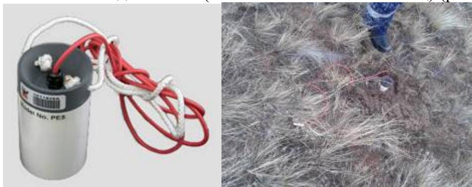
Рис. 5.9 - Неполяризующийся малошумящий электрод PE5
