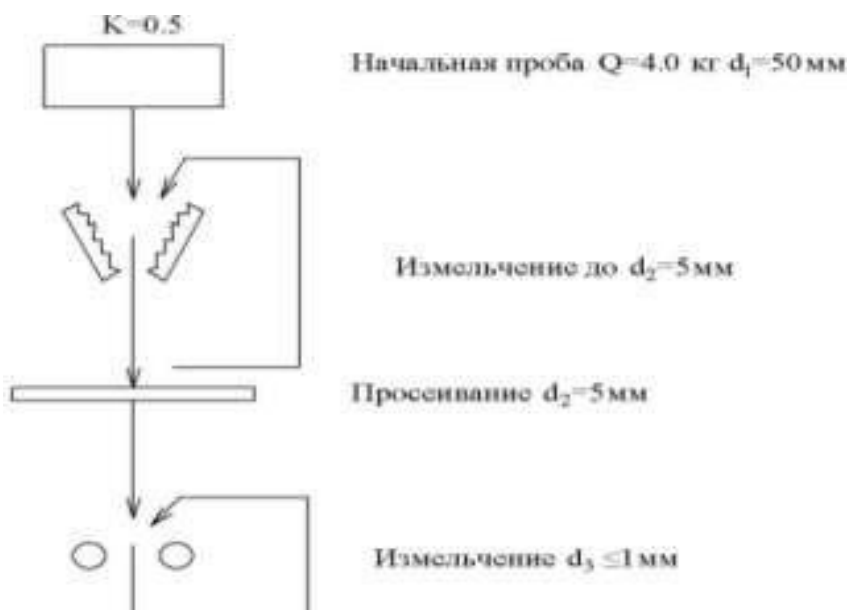
Рисунок 9 (Схема разделки керновых проб)
