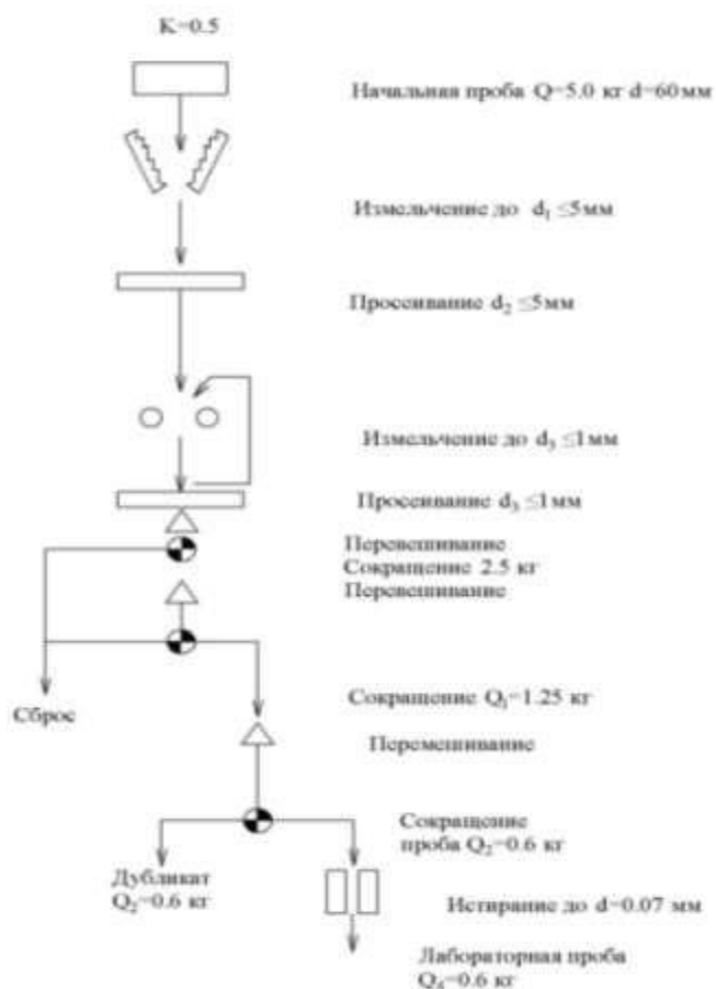
Рисунок 10 (Схема разделки бороздовых проб)
