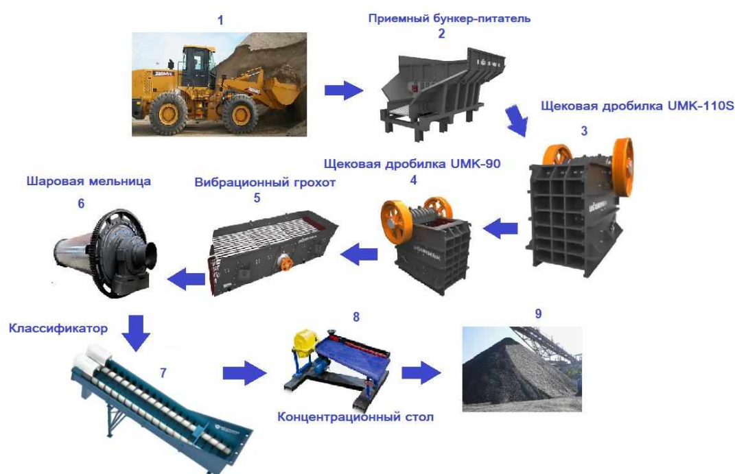
Рис. 5.1 – Схема работы дробильно-сортировочной установки
