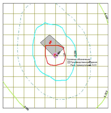
Макс концентрация 8.4086103 ПДК достигается в точке х= 471 y= 333 При опасном направлении 325° и опасной скорости ветра 0.6 м/с Расчетный прямоугольник № 1, ширина 2550 м, высота 2550 м, шаг расчетной сетки 255 м, количество расчетных точек 11\*11
