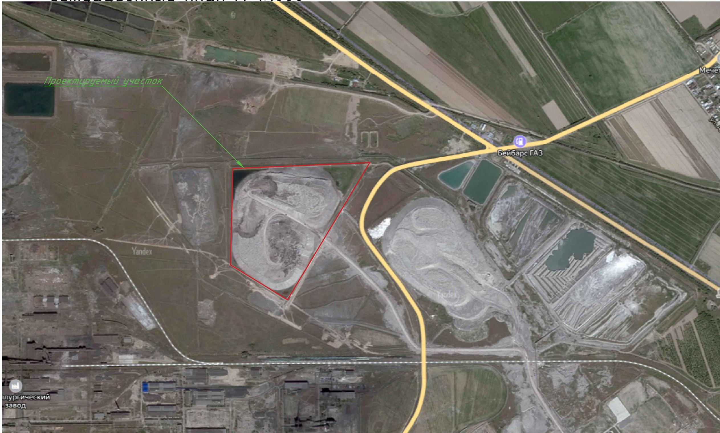
Проектом предусматривается расширение существующего отвала фосфогипса (увеличение высоты до отм. +60,0м) расположенного в Жамбылской области, в районе ТОО "Казфосфат" "Минеральные удобрения". Рельеф площадки инженерно-геологических изысканий представлен с небольшим перепадом, высотные отметки рельефа колеблются в пределах 554,32 до 555,59 м.
