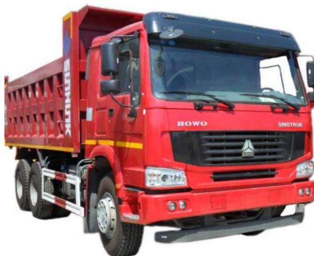
Рисунок 9.2 – Самосвал HOWO A7 грузоподъемностью 25 т
