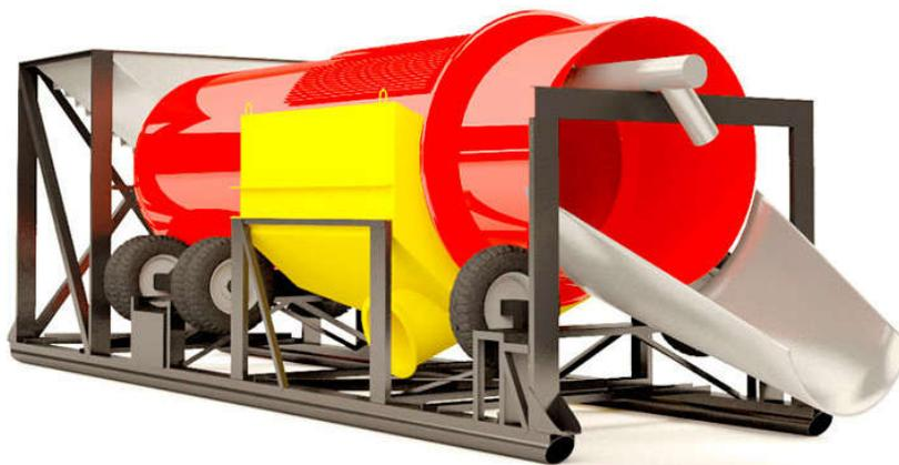
Рисунок 9.3 – Промывочный прибор скруббер-бутара
