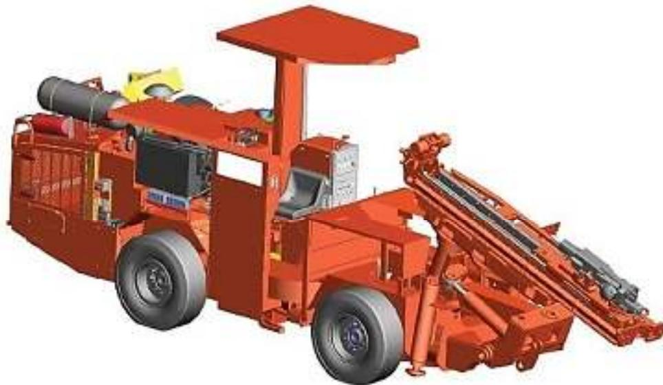
Sandvik DL210 компактная универсальная электрогидравлическая самоходная буровая установка для бурения очистных скважин в шахтах с выработками малого сечения.
