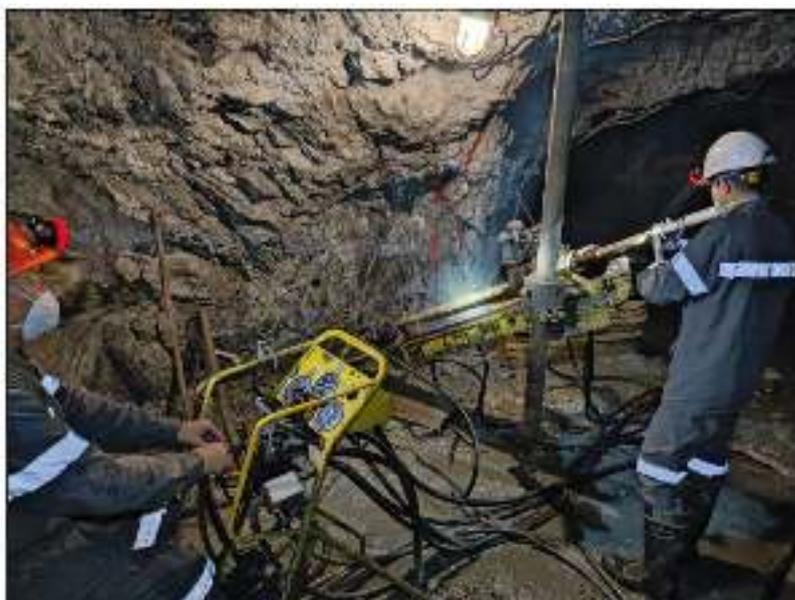
**Рисунок 18.** Установка Diames-232 и буровая бригада в буровой камере.
