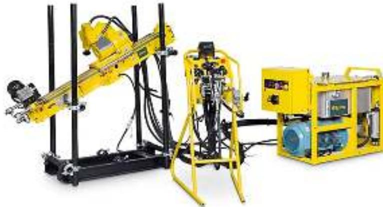
Гидравлическая буровая установка Atlas Copco Diames 232 предназначена для бурения цементуемых скважин в небольших подземных пространствах и узких тоннелях, для отбора керна и для наземного применения в замкнутом пространстве.
