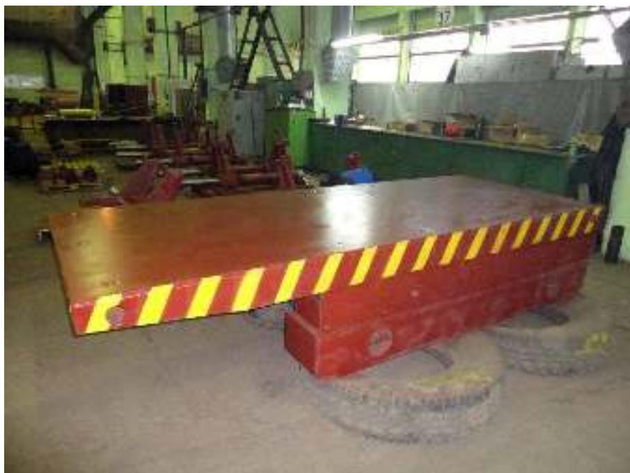
Вибропитатель типа ПВУ предназначен для выпуска руды насыпной плотностью до 4 м<sup>3</sup> и крупностью до 1000 мм. из выпускных выработок блоков, камер и рудоспусков с последующей погрузкой в средства доставки.
