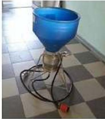
Зарядчики пневматические поршневые нагнетательного типа РПЗ-06 предназначены для зарядки штуров и скважин любого направления гранулированными взрывчатыми веществами.
