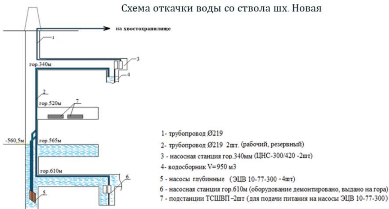
Рис 7.1 Схема откачки воды со ствола шх. Новая
