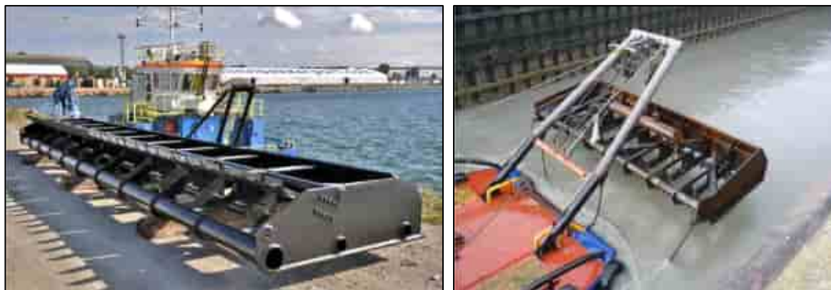
Рисунок 3.5 Пług (слева) и пług, подвешенный на раме на корме буксирного судна (справа)
