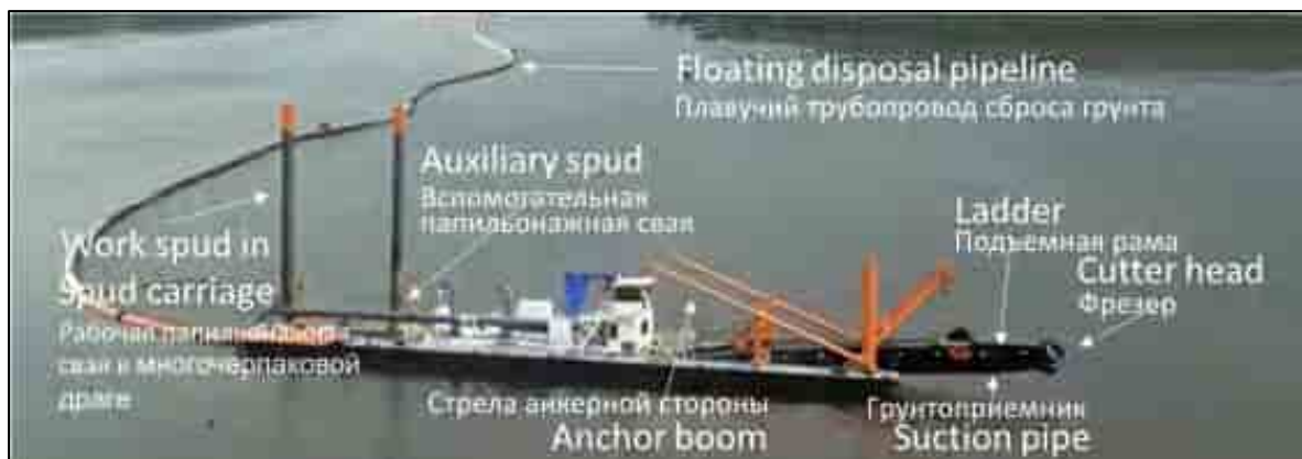
Рисунок 3.4 Фрезерный земснаряд
