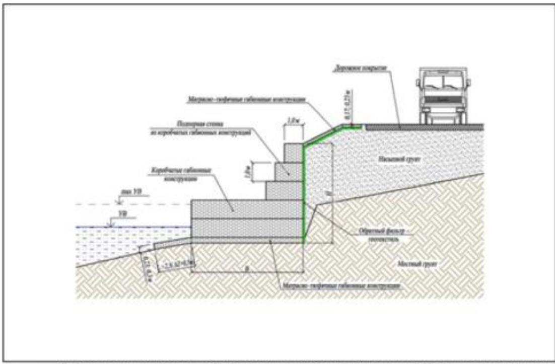
В целях безопасности на косогоре вдоль матрасно-тюфячных габионов на расстоянии 2,0м устанавливаются ограждения из сетки «Рабица» размером 3,0x1,5м, обрамленные уголками. Общая протяженность ограждения 500м.
