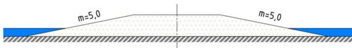
Рис. 2.3. Поперечный профиль грунтовой запруды
