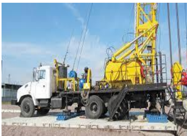
Рис. 6.4. Установка УПА 60/80 для освоения и ремонта скважин
