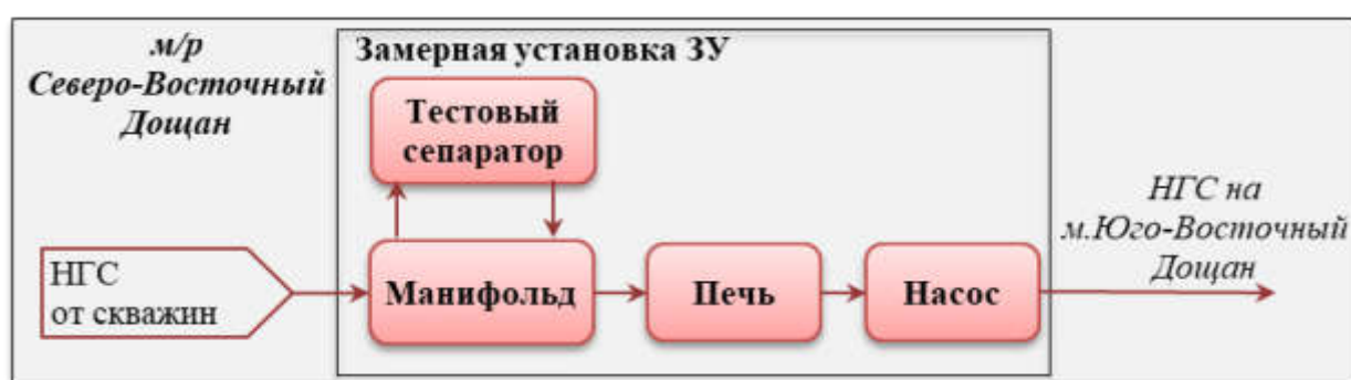
Рисунок 6.3.1 - Принципиальная схема системы сбора и транспортировки
