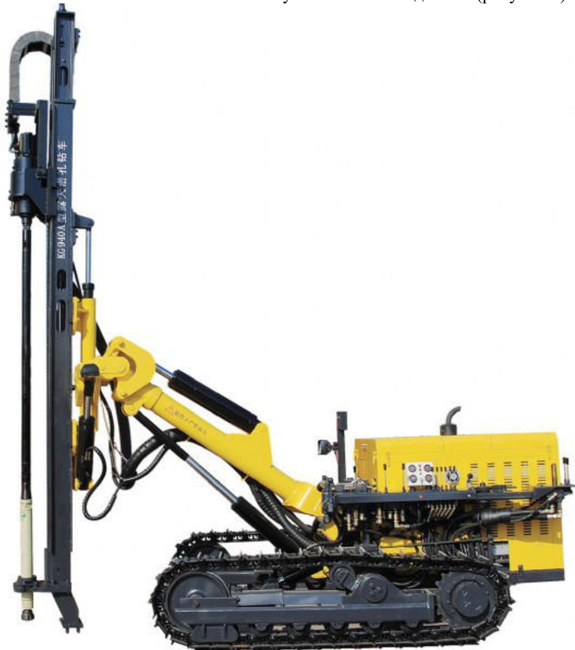
Рисунок 2. Буровая установка KAISHAN KG940A
