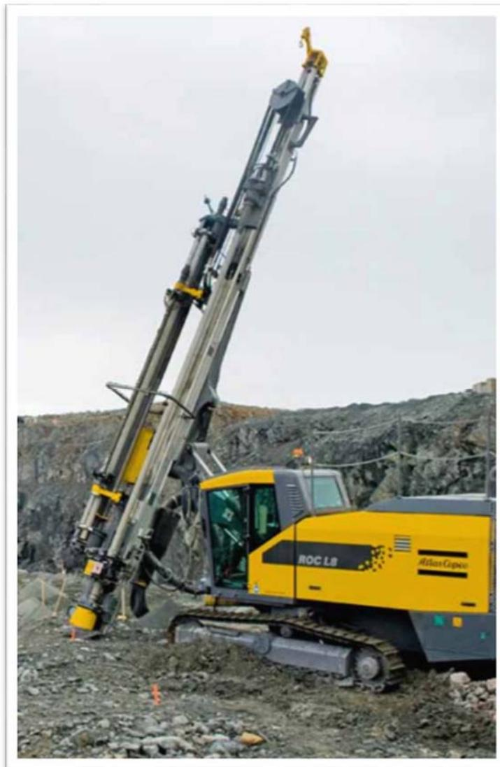
Рис. 6.4 Буровой станок ROC-L8
