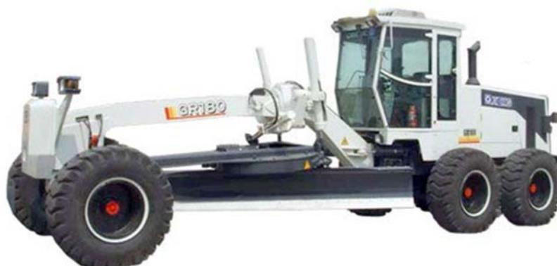
Рисунок 6.15 - Автогрейдер XCMG GR180
