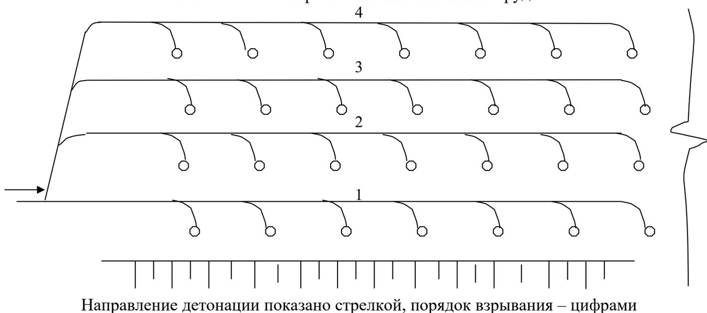
Рис. 6.9- Схема взрывной сети
