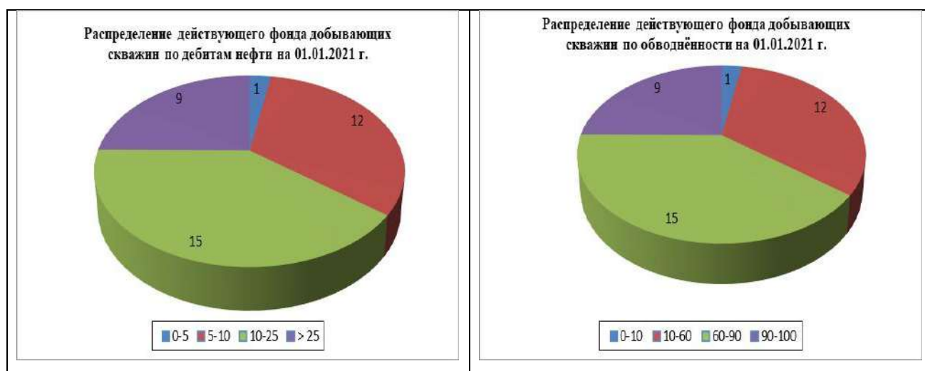
Рисунок 3.2.3 – Контрактная территория ТОО «СО». Распределение действующего фонда добывающих скважин по дебитам нефти и обводнённости по состоянию на 01.01.2021 г.
