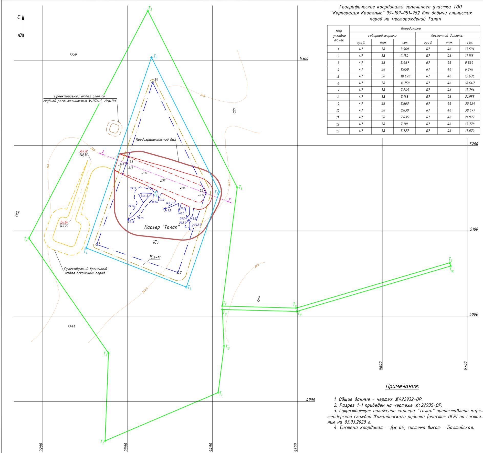
Проектируемый отвал слоя со скудной растительностью V=376м<sup>2</sup>, Нср=3м
