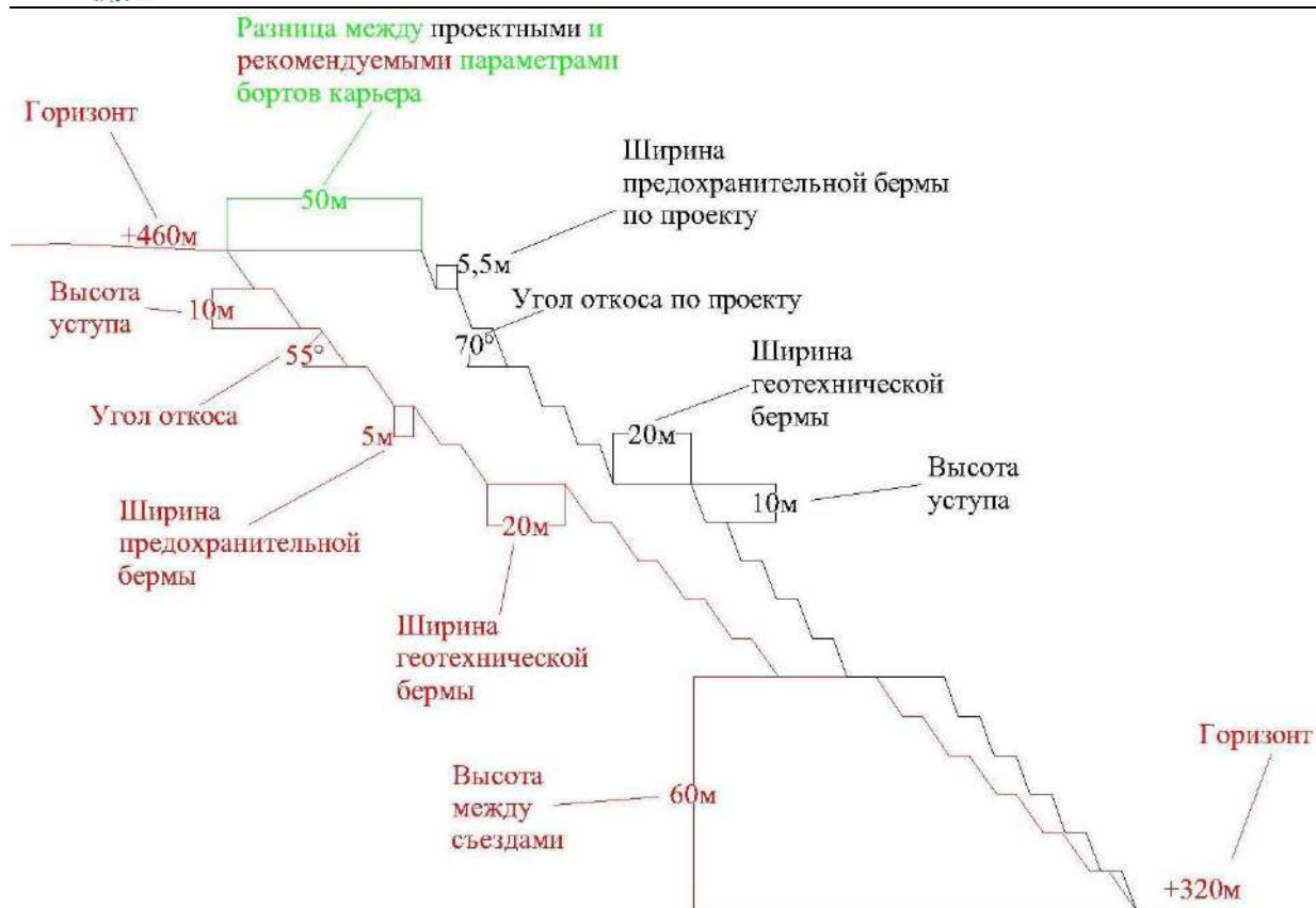
Рисунок 25 - Сравнение рекомендуемых параметров карьера по домену А с проектными параметрами
