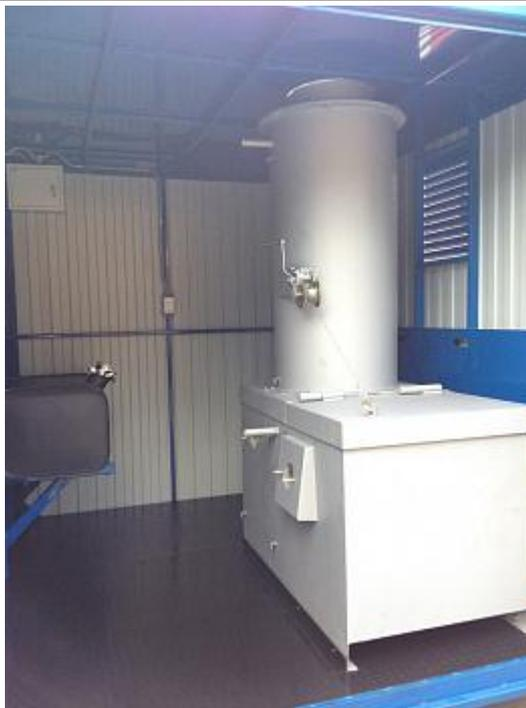
**Рисунок 1.8. - Инсинератор «ИНСИ В-150»**
