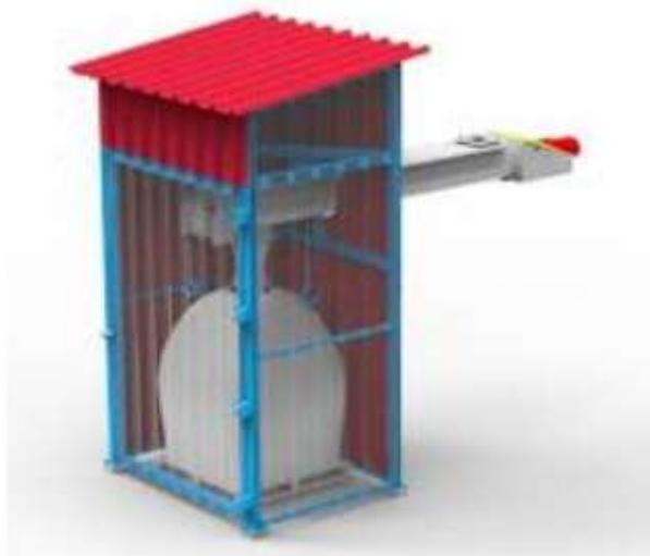
Рисунок 5: Элемент собирания (хранения) пыли
