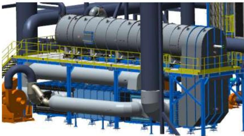
Рисунок 2: Камера сгорания
