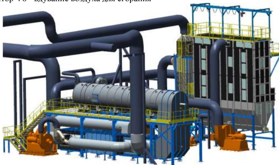
Рисунок 1.5 - Общий вид устройства очистки и дожига ваграночных газов
