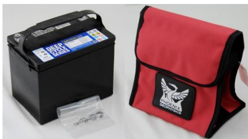
Рис. 5.6 - Система автономного питания регистраторов и генератора
