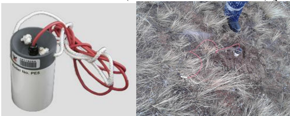
Рис. 5.9 - Неполяризующийся малощумящий электрод PE5
