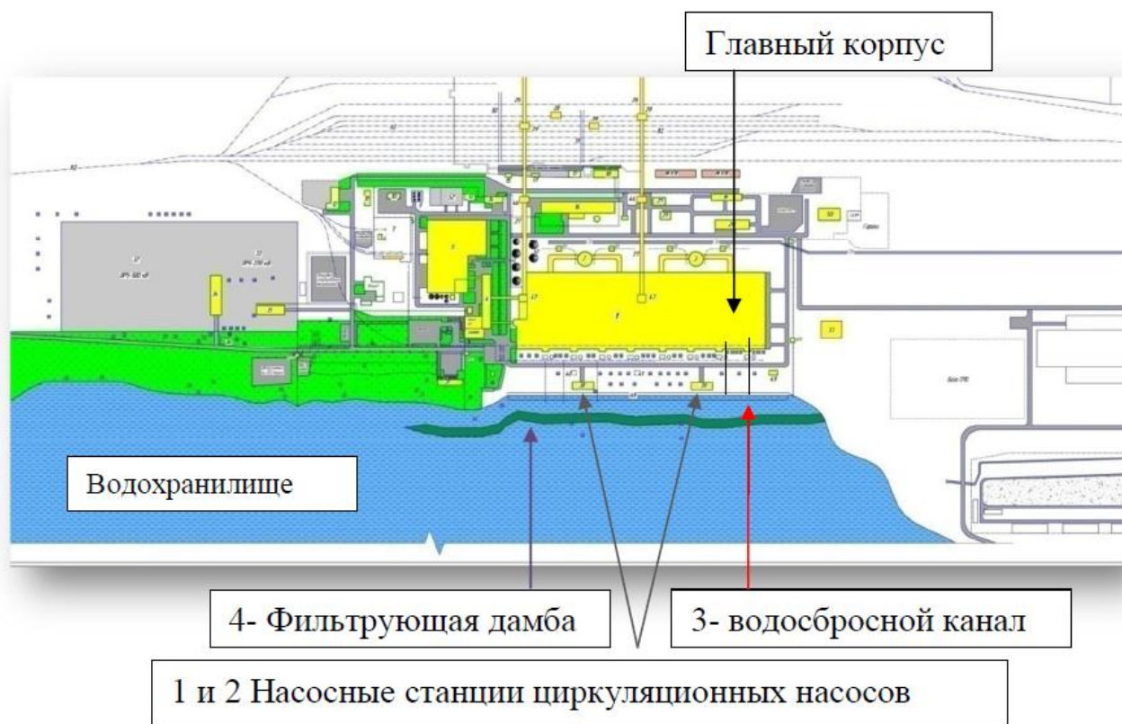
Рисунок 6.6.1 Размещение объектов технического водоснабжения на ГРЭС-1
